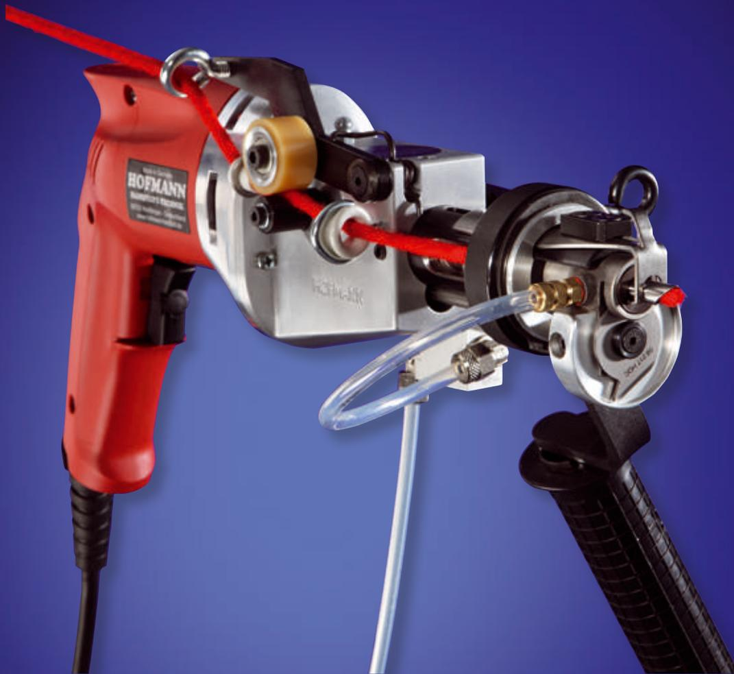
Mit unserer VML 16 Handtuftmaschine für Schnitt- und Schlingenflor ist es sehr einfach, handgefertigte Teppiche mit einer Vielzahl von Designs zu produzieren.
